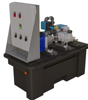
Enquanto a bomba de superfície estiver a aspirar efluente tratado, aspirará também uma dose determinada de solução de hipoclorito de sódio de modo a que se proceda à desinfecção em linha do efluente. O conjunto formado pela tubagem da rede e os reservatórios dos autoclismos fornecerá o tempo de contacto necessário para que o agente desinfectante actue sobre os micro-organismos potencialmente patogénicos.
