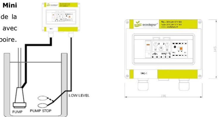
La Station de Pompage Compacte ECODEPUR® ECO BST e ECODEPUR® ECO BST PLUS est commandé par le panneau électrique EPIC 2D, avec contrôle et protection de deux pompes submersibles mono ou triphasées avec alternance automatique, commandée par 4 interrupteurs de niveau, bouées du type poire, pouvant être commandée par sonde analogique (par exemple, une sonde piézométrique).
